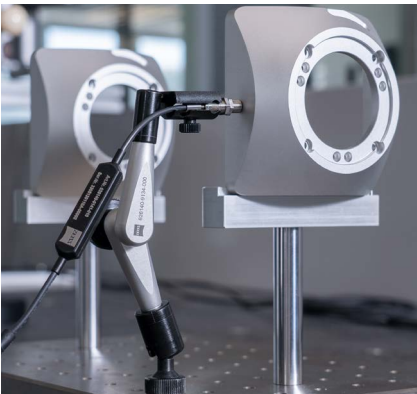
Werkstück-Temperaturmessung mit Gelenkarm.
